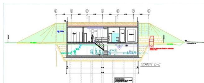
Der Bau des neuen Wasserhauses mit Saugbehälter hat im März begonnen. Die Fertigstellung ist im Jahr 2026 geplant. Es entsteht ein Flachgebäude, an der Oberfläche komplett begrünt.
